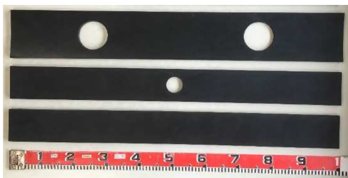
支承用ゴム クロロプレングム(CR)はHC床版と受台の間に使用します。
