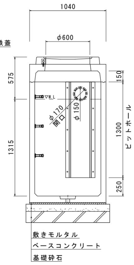
油水分離槽文字 铸铁丸蓋
