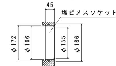
排水ピット(止水栓)詳細図
