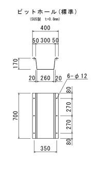
排水ピット(栓付)詳細図 52 ゴムパッキン φ74  $\phi$  50
